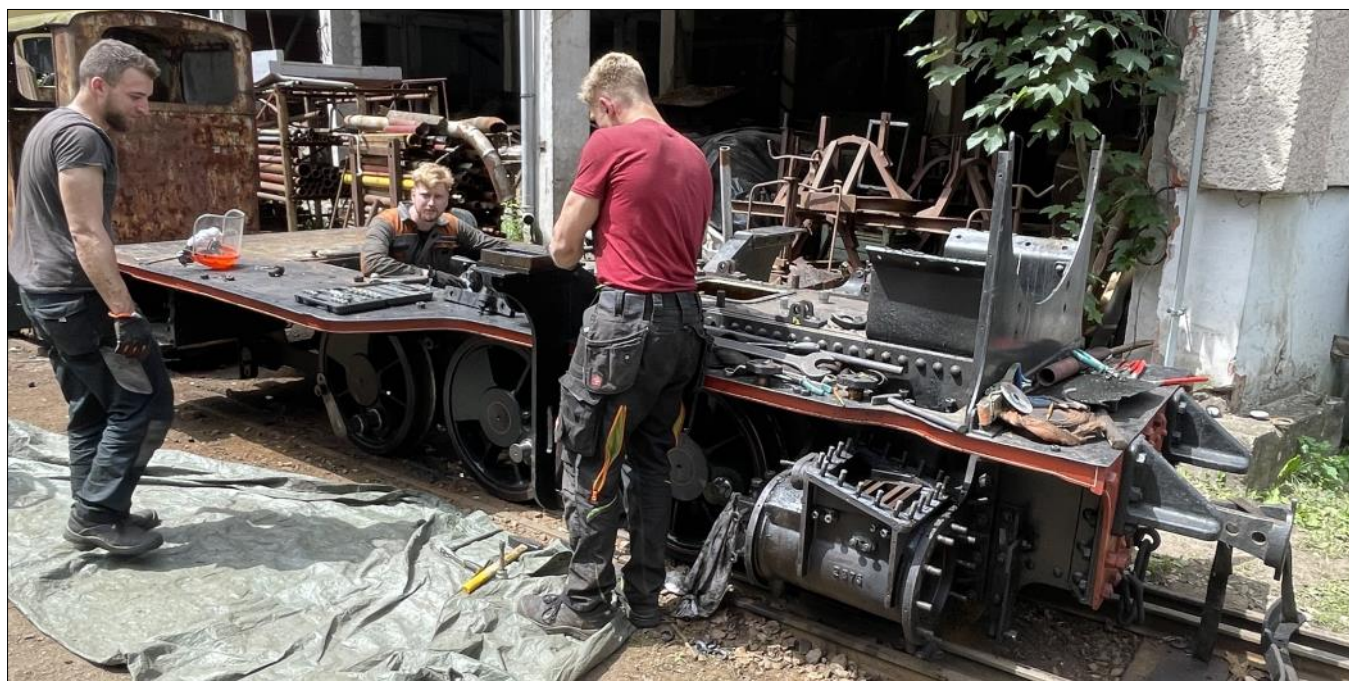
Demontage der Dampflokomotive 2 „Urskog“ des des Norsk Jernbanemuseums.
