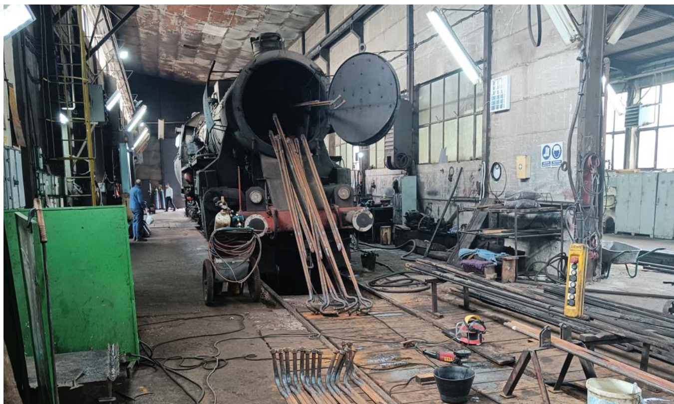
Eine Bosnien-Baureihe 33 steht im Schuppen in Tuzla und wartet auf die Umrüstung ihrer Überhitzerelemente am 24. April 2024. Foto: Ian Leigh
