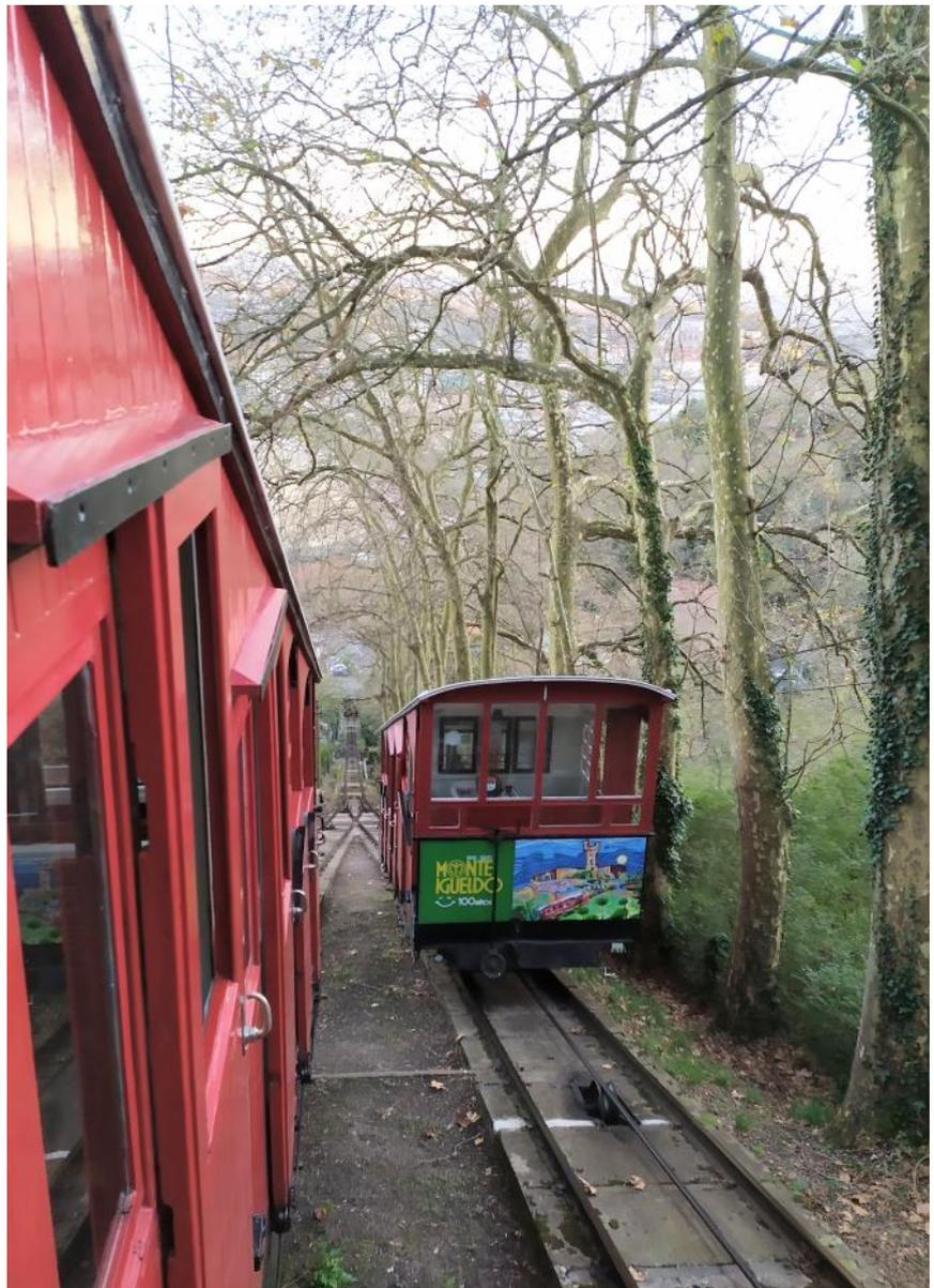
Steigung von maximal fast 60 % und in einer Geschwindigkeit von 1,5 Metern pro Sekunde. Jedes Fahrzeug hat fünf Abteile und eine Kapazität von 50 Personen. Die Bahnen fahren alle 15 Minuten, wobei die Frequenz in Spitzenzeiten erhöht wird. ([www.monteigueldo.es](http://www.monteigueldo.es))
